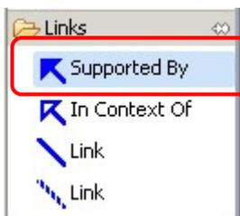
この図では「Supported By」リンクが選択されています。この状態で D-Case エディタのキャンバス上にあるリンク元のノードからリンク先のノードへマウスをドラッグ移動して離すと、新しい「Supported By」リンクが、ノードとノードの間に引かれます。
