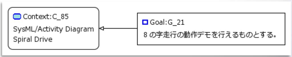
**SysMLの振舞い図をコンテキストとして関連付けることで、参照すれば振舞いについて捕捉できることを示すことができる。**
